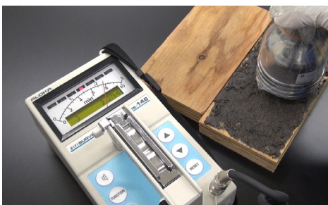
▲GMサーベイメータで表面汚染の測定
